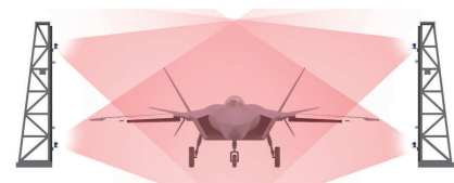
大场景高精度数字化测量场景示意图
